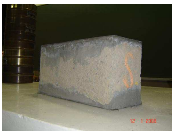
Figura 21 - Bloco reciclado capeado.
