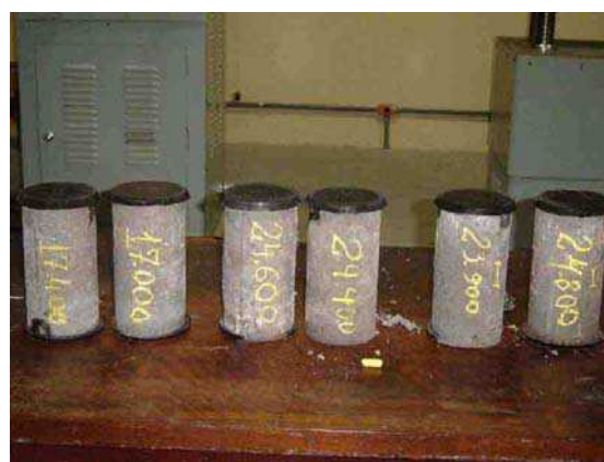
Figura 14 – Corpos de prova rompidos.
