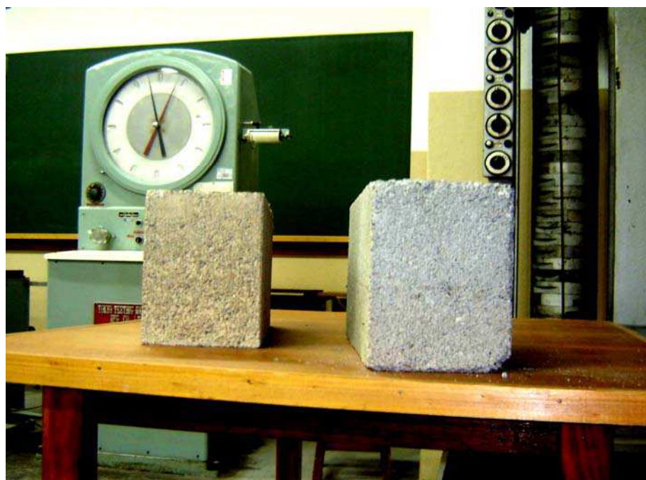
Figura 34 – Diferença de coloração entre o bloco reciclado (esquerda) e o convencional.
