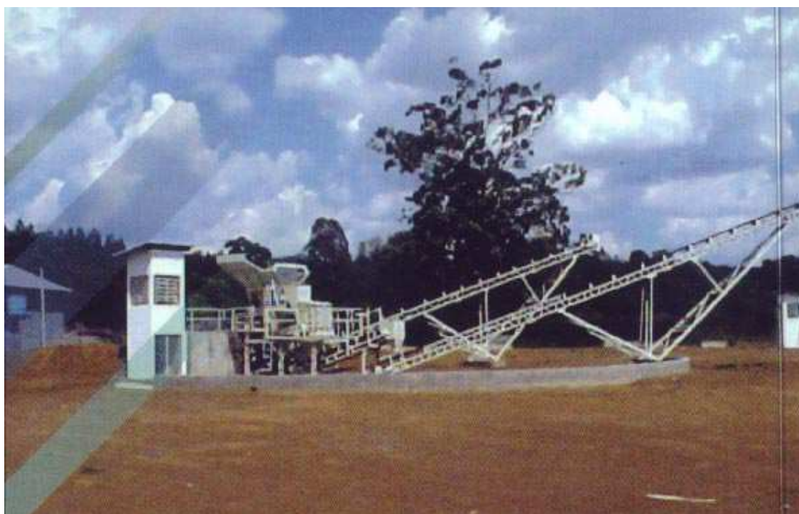
Figura 09 – Equipamentos necessários para reciclagem dos RCD.
