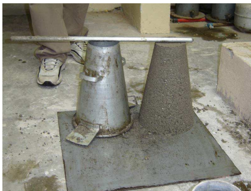
Figura 30 – Realização do Slump-test – variação de 0 a 1 cm.
