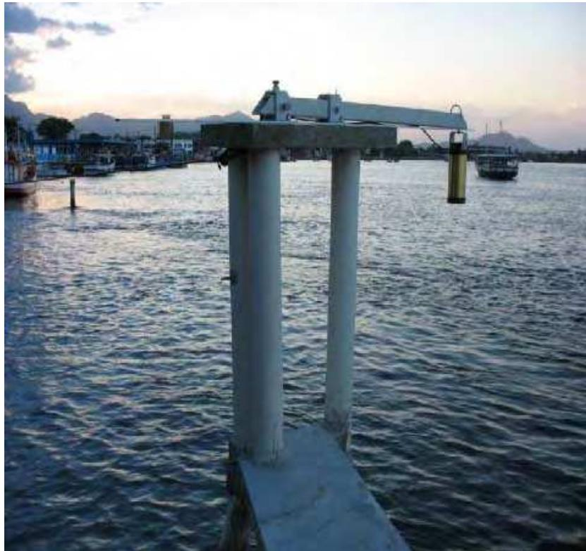
Figura 27 - Estação meteorológica de superfície - pressão, vento, chuva e radiação solar.
