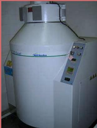
**Figura:** Irradiador de Cobalto-60 da COPPE-RJ
